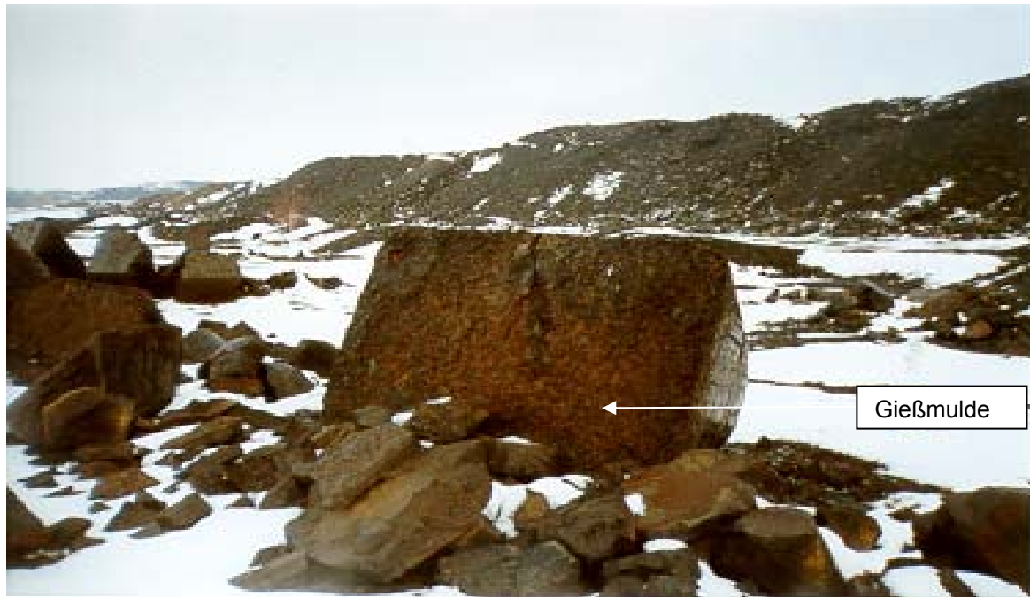
Abb. 2: Ausgegossene Gießmulden ( 2\text{m}^3 , ca. 5t) auf der Halde
