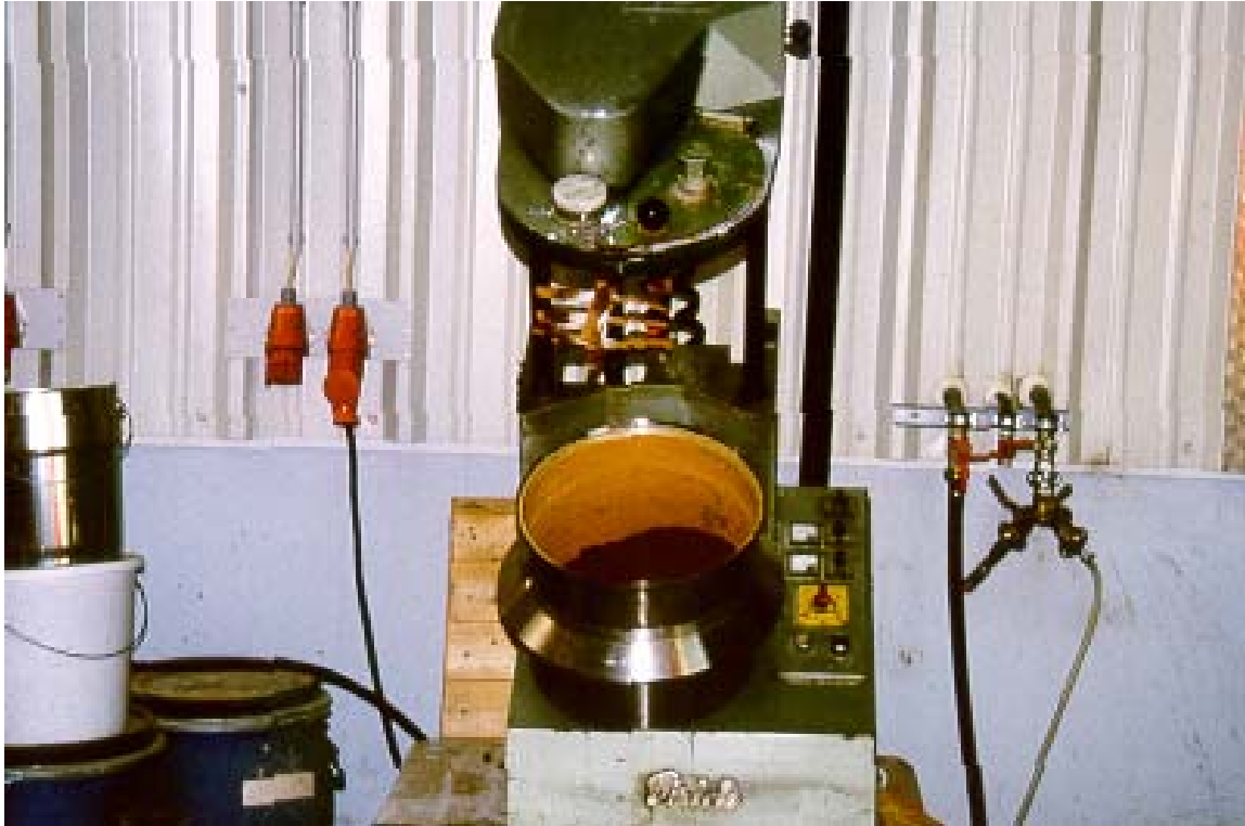
Abb. 6: Zwangsmischer (Pelletierer) der Firma Bilfinger und Berger
