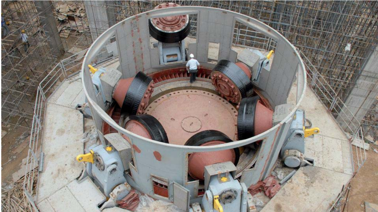
Abbildung 22: Wälzmühlenbett einer Vertikalwälzmühle der Fa. Loesche GmbH (Foto: Loesche GmbH)
