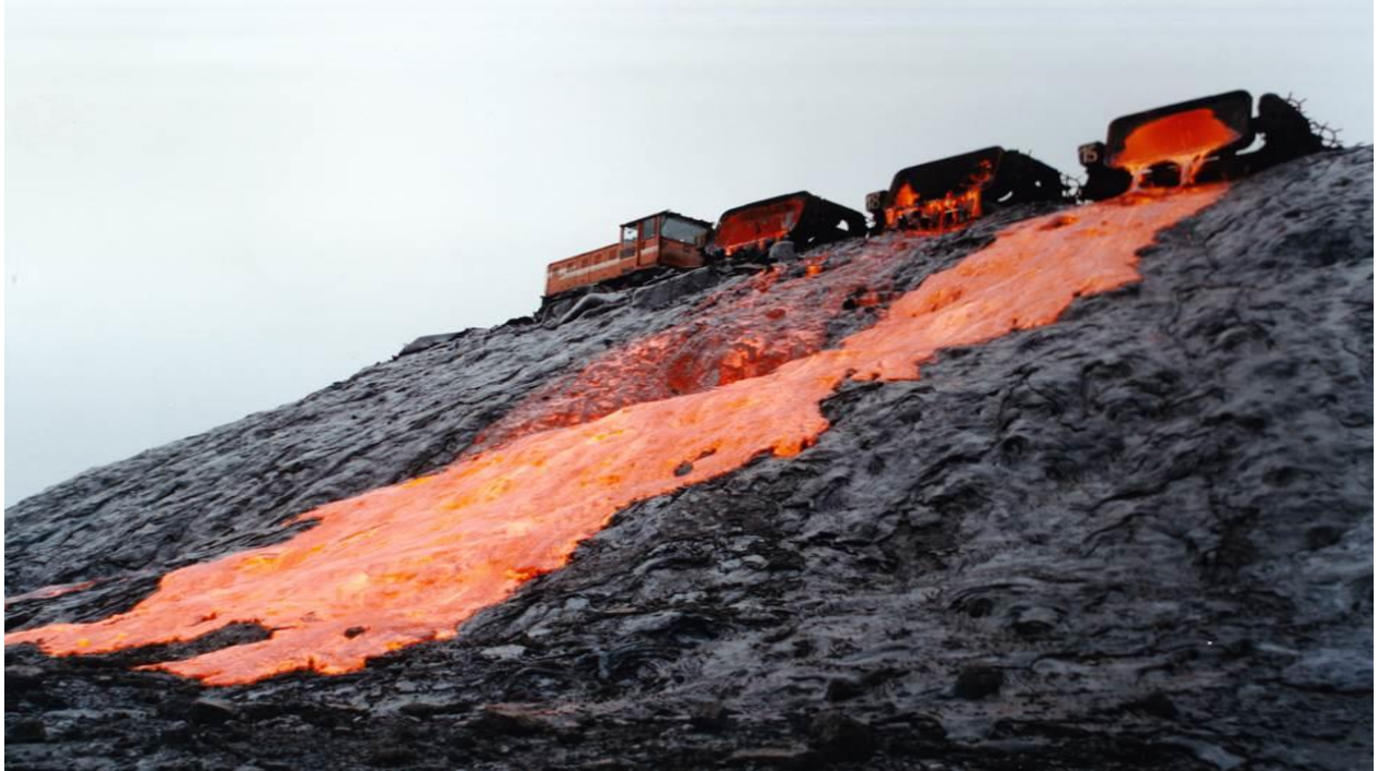
Abb. 1: Abkippen von Kupferschlacke beim Schachofenbetrieb der Rohhütte Helbra (aus dem Archiv von Dipl.-Ing. Horst Zobel, Eisleben)
